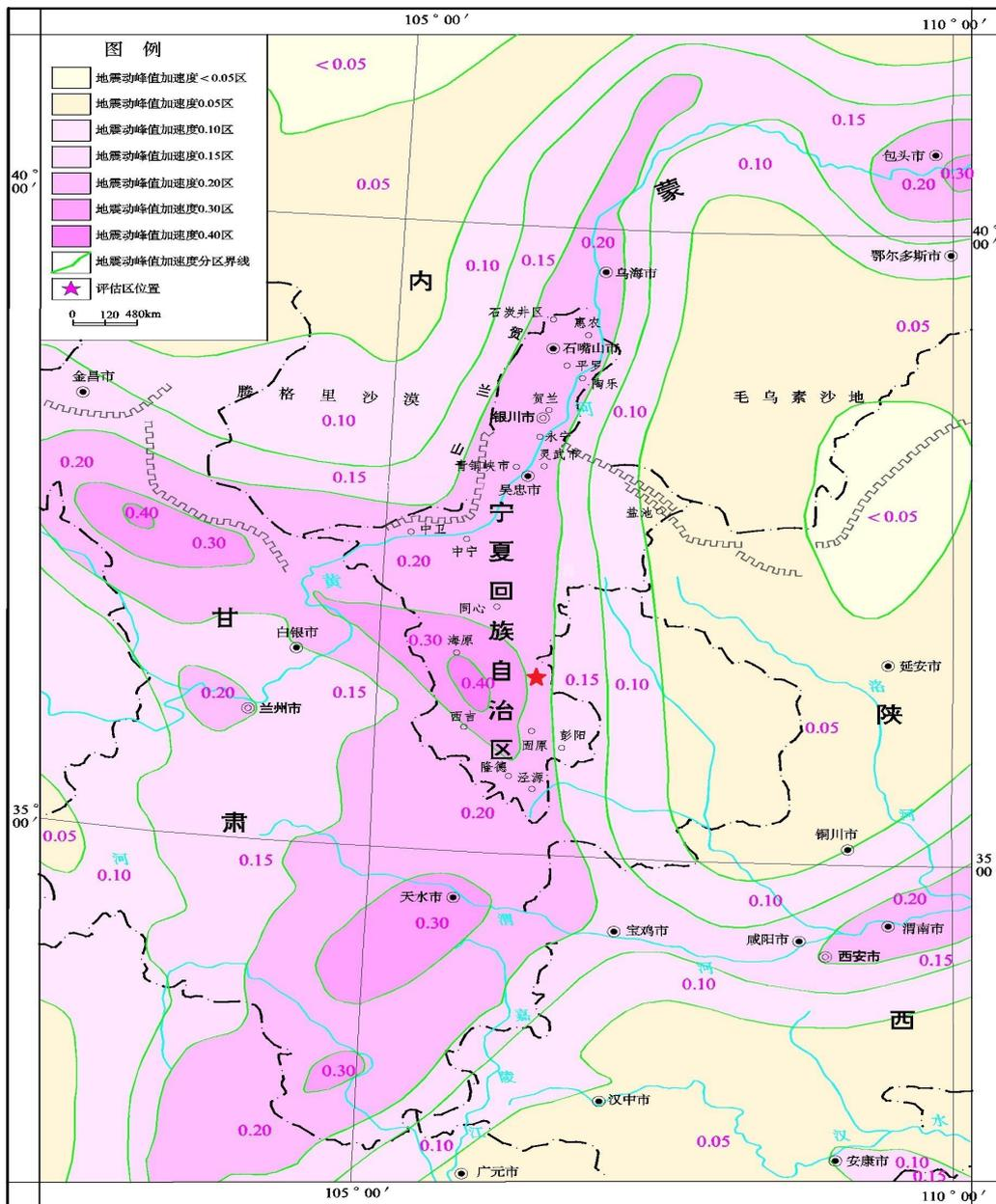
图 2-1 地震动峰值加速度系数区划图
